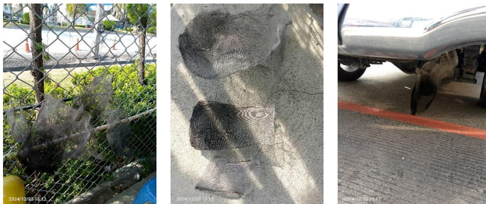
ภาพที่ 2-17 อุปกรณ์ดักจับลูกไฟติดกับท่อไอเสียรถยนต์
